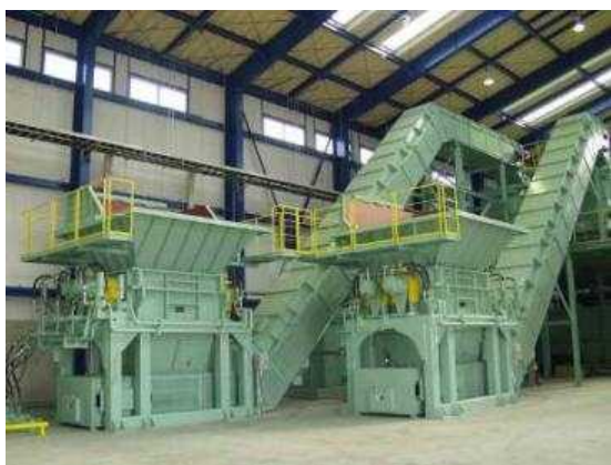
図 4-3 破碎機の屋内設置（例）
