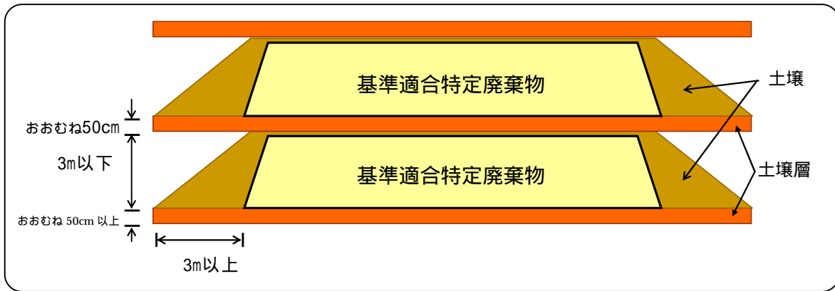
図 5-17 土壌層と層状埋立のイメージ図
