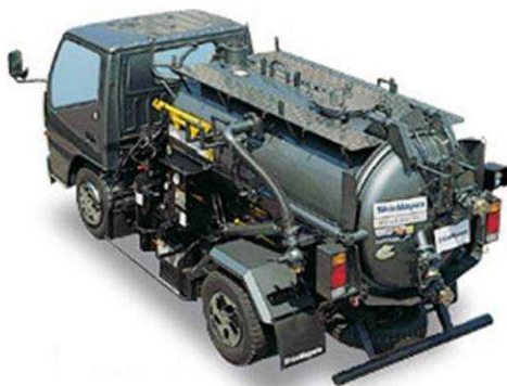
図3-2 汚泥吸排車(例)
