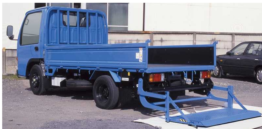
図 3-7 平ボディ車(リフタ付)(例)
